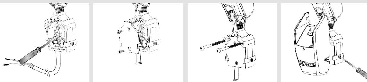
Провода подключаются в соответствии с расположением клемм.
