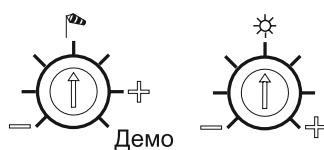
Пороговые значения для ветра и солнечного излучения могут устанавливаться на устройстве Soliris Sensor RTS с помощью потенциометра **ветер** и **солнце**. (ветер – примерно 10 - 50 км/час, интенсивность солнечного излучения около 0-50 клюкс.)
